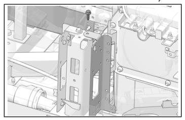
PASSENGER SIDE BATTERY ENCLOSURE PANEL REMOVAL
