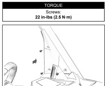
3. Install push pin rivet.
