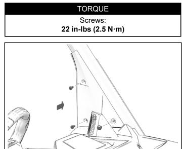
3. Install push pin rivet.
